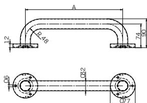
Нержавеющая сталь, гладкая поверхность, полированная. Монтаж с накладками 77 мм, с отверстиями для 3 болтов. Дополнительные накладки из полированной нержавеющей стали для крепежных болтов.
