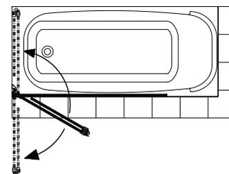
На рисунках - схема складывания ширмы двухсекционной левой FPNF12222008L
